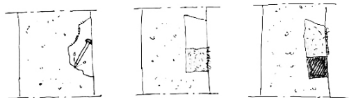
priprema zidova, testiranje pukotina i način ispune pukotina u zavisnosti od veličine
